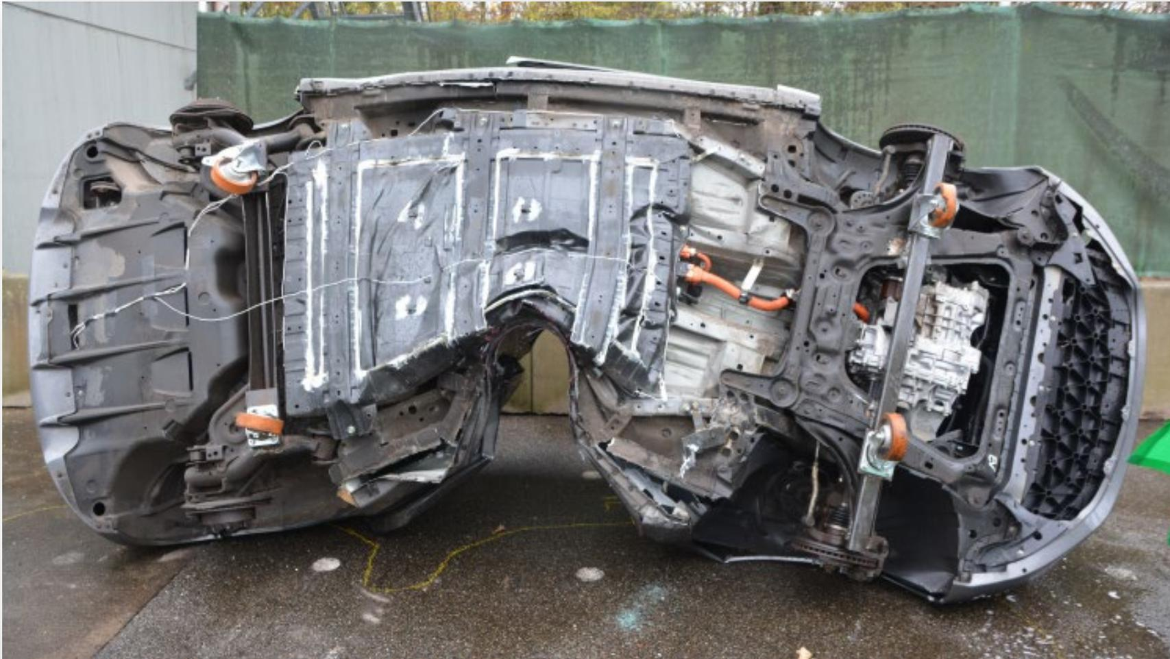
Trotz massiver Verformung – auch der Traktionsbatterien – ist bei keinem der vier Versuche das Fahrzeug in Brand geraten.
